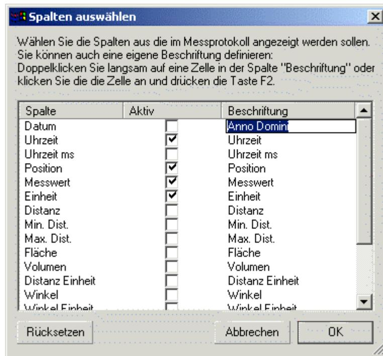
Hier können die Spalten ausgewählt werden, die im Messprotokoll angezeigt werden sollen. Durch ein langsames Doppelklicken auf eine Zelle in der Spalte "Beschriftung" kann die Beschriftung der Spalte im Messprotokoll verändert werden. Alle Änderungen werden sofort in das Messprotokoll übernommen.
