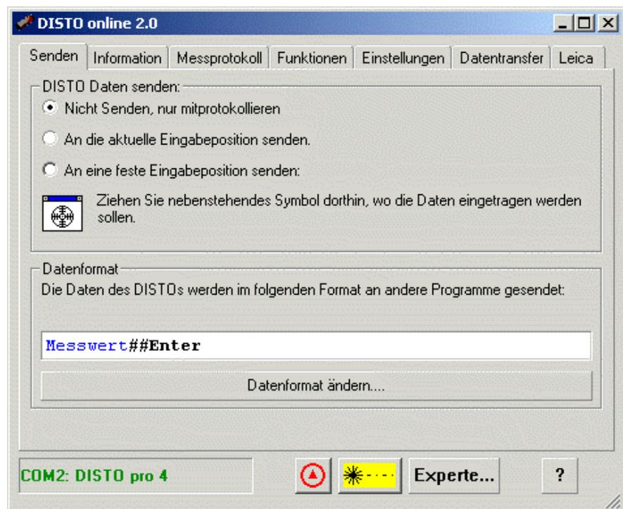
Die Seite "Senden" wurde insofern erweitert, als nun die Messwerte immer an eine feste Position einer Anwendung geschrieben werden können. Dies ist besonders bei verschiedenen Anwendungen im CAD Bereich von Hilfe, oder
