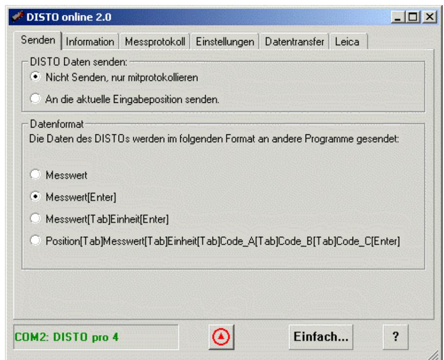
Das Fenster ist in zwei Bereiche aufgeteilt. Im oberen Teilbereich wird definiert, was mit den Daten geschehen soll, d.h. wohin werden diese übertragen. Im unteren Bereich der Seite wird das zu sendende Datenformat definiert. Vier vordefinierte Formate sind möglich:
