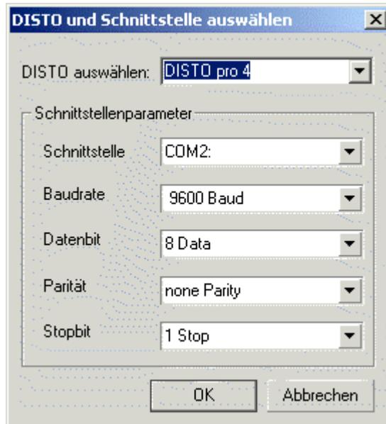
Es können hier das DISTO Modell, und die Schnittstelleneigenschaften frei ausgewählt werden. Wenn aus der Auswahlliste "DISTO auswählen" ein DISTO Modell ausgewählt wird, so werden die Schnittstellenparameter für dieses DISTO Modell automatisch gesetzt.
