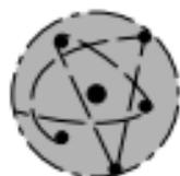
DISTO großzügig um den Zielpunkt schwenken. Das Gerät mittelt die Abweichungen und findet den kleinsten Wert selbst. Die beiden Flächen (z.B. Boden / Decke) müssen ungefähr parallel sein.
